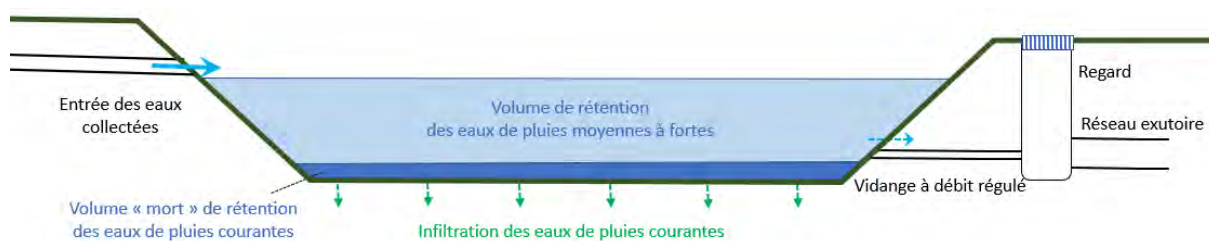
Schéma de principe de gestion des pluies courantes dans un « volume mort » aménagé dans le dispositif de rétention-régulation des pluies moyennes à fortes
